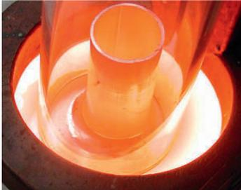
**Induktionslöten einer Edelstahl-Lötverbindung unter Schutzgas (Löttemperatur: 1000°C, Quelle: Umicore BrazeTec, Brazing Center Hanau)**
