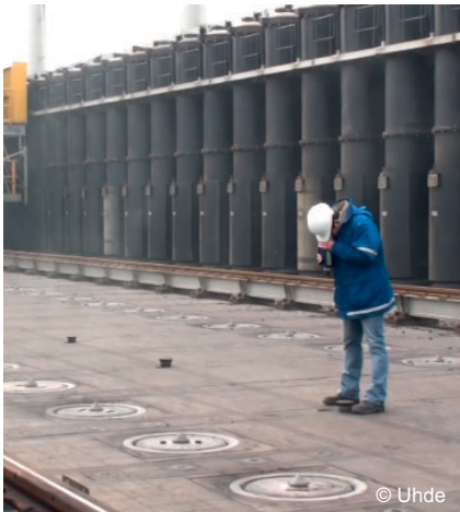
Messung der Koksofentemperaturen von der Ofendecke durch die Inspektionslöcher
