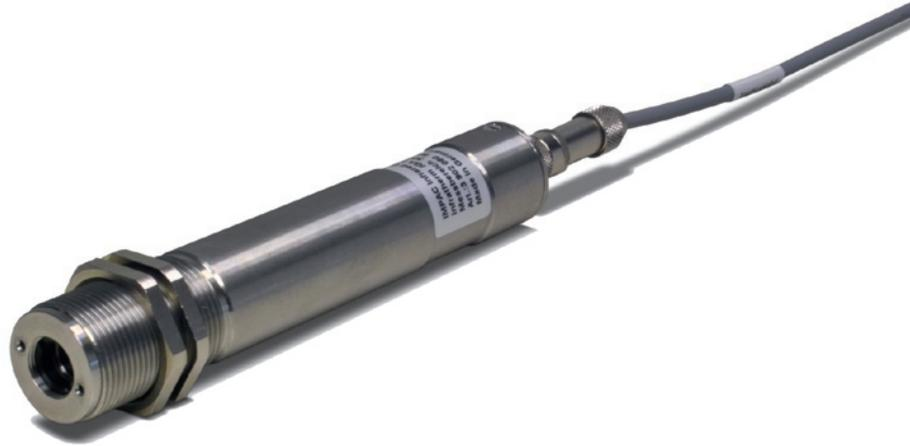
**IS 310** 和 **IGA 310** 是固定式测温仪，用于金属表面、石墨、陶瓷等的非接触式温度测量。
