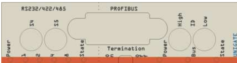
Bild 2: Frontblende: Drehschalter und Leuchtanzeigen
