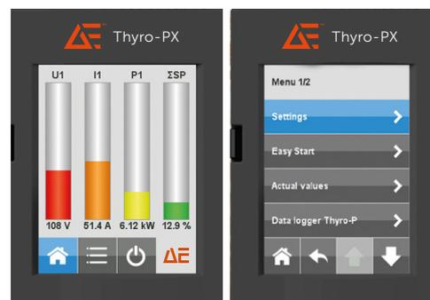
Das Thyro-Touch Display bietet neben der einfacheren Handhabung des Thyro-PX™ Thyristor-Leistungsstellern eine umfangreiche Auswertung der Messwerte. Die laufende Datenerfassung kann in Form von Linien- oder Balkendiagramm, als Betriebsanzeige oder im Daten-Recorder angezeigt werden.
