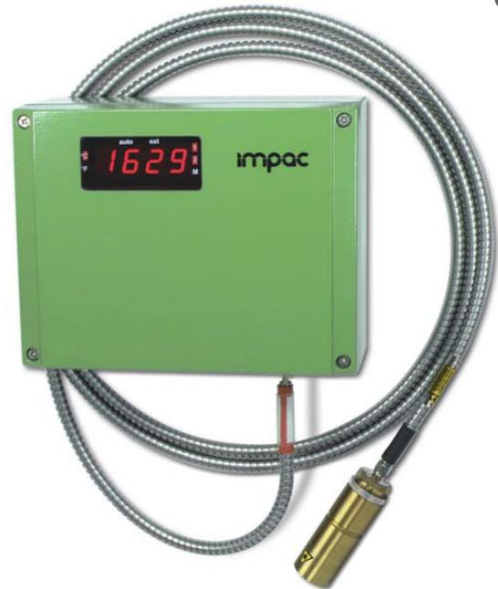
Die Pyrometer ISR 12-LO und IGAR 12-LO sind digitale, hochgenaue Quotienten-Pyrometer mit Lichtleiter zur berührungslosen Temperaturmessung.
