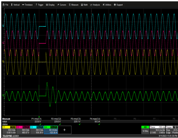
Figure 19: ORV3 Shelf Inrush Current Vin = 230Vac(L-N) (3 phases drop for 20ms) Io = 150A Ch 1: Vin (L1-N) Ch 2: Vin (L2-N) Ch 3: Vin (L3-N) Ch 4: Iin
