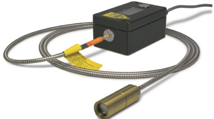
Die Pyrometer **IS 50-LO plus** und **IGA 50-LO plus** sind digitale, hochgenaue Infrarot-Messgeräte mit Lichtleiter zur berührungslosen Temperaturmessung an Metallen, Keramik, Graphit etc. zwischen 250 und 3500 °C.
