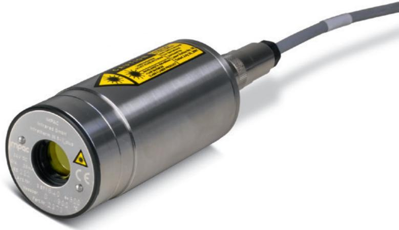
Das IN 5/9 plus wurde speziell für die berührungslose Temperaturmessung von Saphir und Saphir-Wafern entwickelt.
