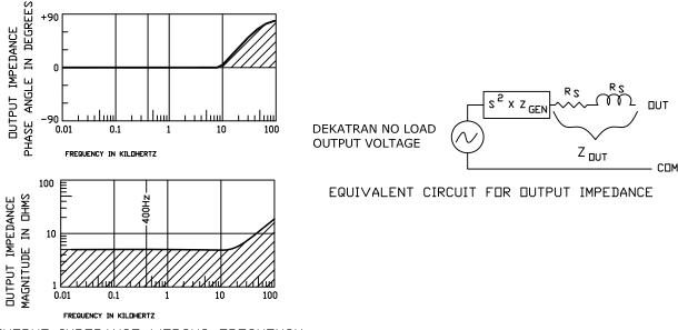
DUTPUT IMPEDANCE VERSUS FREQUENCY
