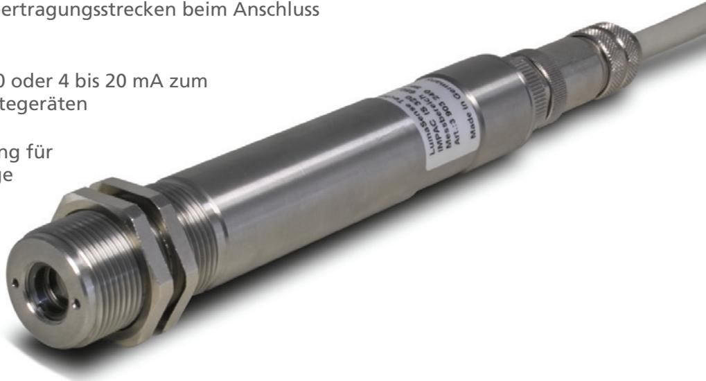
Die IMPAC-Pyrometer IS 320 und IGA 320 sind kurzwellige Infrarot-Messgeräte mit interner digitaler Signalverarbeitung. Sie werden eingesetzt zur berührungslosen Temperaturmessung z.B. an Metallen, Keramik und Graphit.
