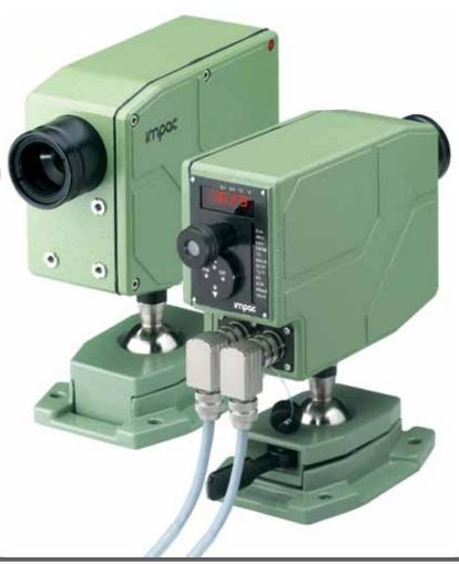
Das IS 12-Al ist eine Spezialversion des Pyrometers IS 12, entwickelt zur Messung von Aluminium.
