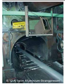
Das **IS 12-Al** ist die konsequente Weiterentwicklung des bewährten IS 10-Al zur Messung von Aluminium bei Temperaturbereichen zwischen 350 und 1050°C.
