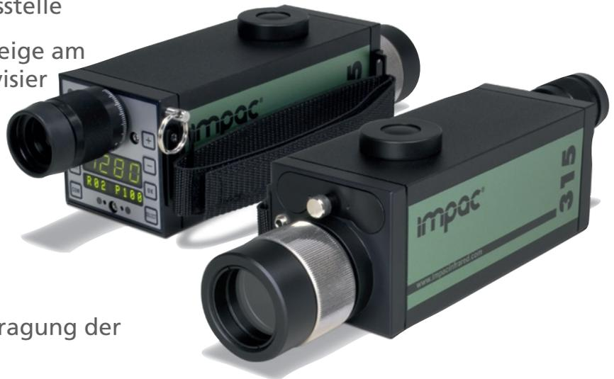
Das Handpyrometer IGA 315-K wurde speziell zum Einsatz in Kokereien entwickelt. Es wird für die berührungslose Temperaturmessung der Düsensteine und der Luftstufen in Koksöfen verwendet. Die Messung wird von der Ofendecke nach Öffnen der Heizzugdeckel durchgeführt. Hierfür ist der Strahlengang des Messgerätes so modifiziert, dass der Düsenstein problemlos durch die kleine Sichtöffnung anvisiert und selbst in einer Entfernung von bis zu 12 m exakt gemessen werden kann.
