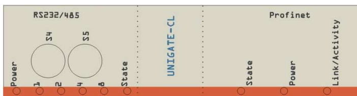
Bild 2: Frontblende: Drehschalter und Leuchtanzeigen
